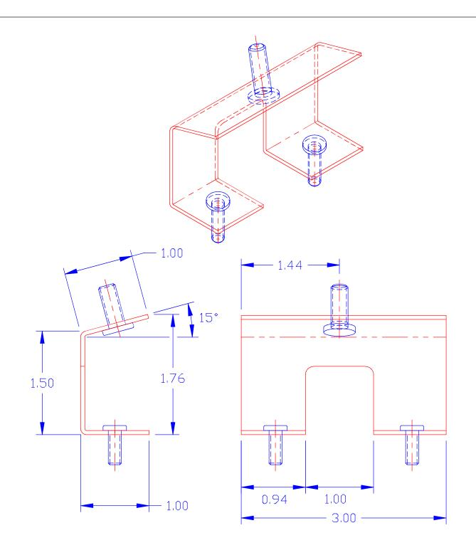
WIPER MOTOR SUPPORT BRACKET FOR MGA TO BE FORMED AS SHOWN ON NEXT PAGE
